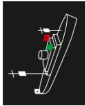
Maschinenfahrzeug in Fahrt über 50 m Länge
