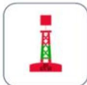
Backbordseite des Fahrwassers, Steuerbordseite des abzweigenden/einmündenden Fahrwassers
