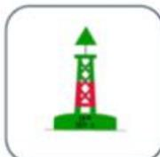
Steuerbordseite des Fahrwassers, Backbordseite des abzweigenden/einmündenden Fahrwassers
